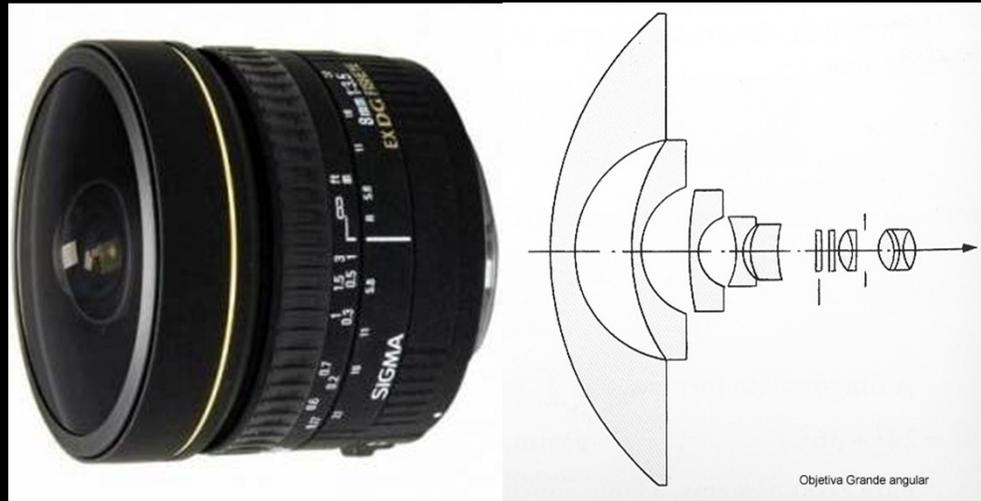
Ao passo que uma grande angular pode variar de  $150^{\circ}$  a  $22^{\circ}$  de abrangência, o que toma mais área, mas em compensação, provoca deformações de perspectiva na imagem
